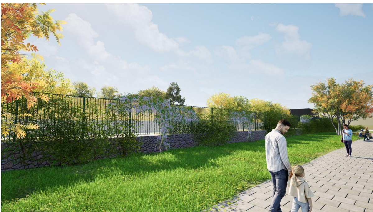
Řešení plotu II. etapy - podél dlážděné parkové promenády, konstrukce doplněna nerezovou sítí pro popínavky
